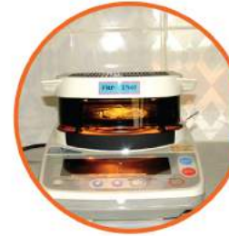
Cân xác định độ ẩm vật liệu Scales to determine humidity
