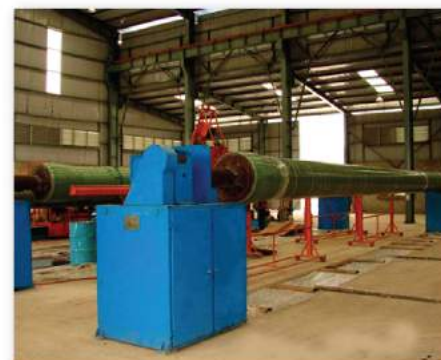
TRẠM CỨNG HÓA Curing station
