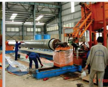
MÁY CUỐN ỐNG KẸP CÁT ĐIỀU KHIỂN MÁY TÍNH Computer controlling adding mortar - winding machine
